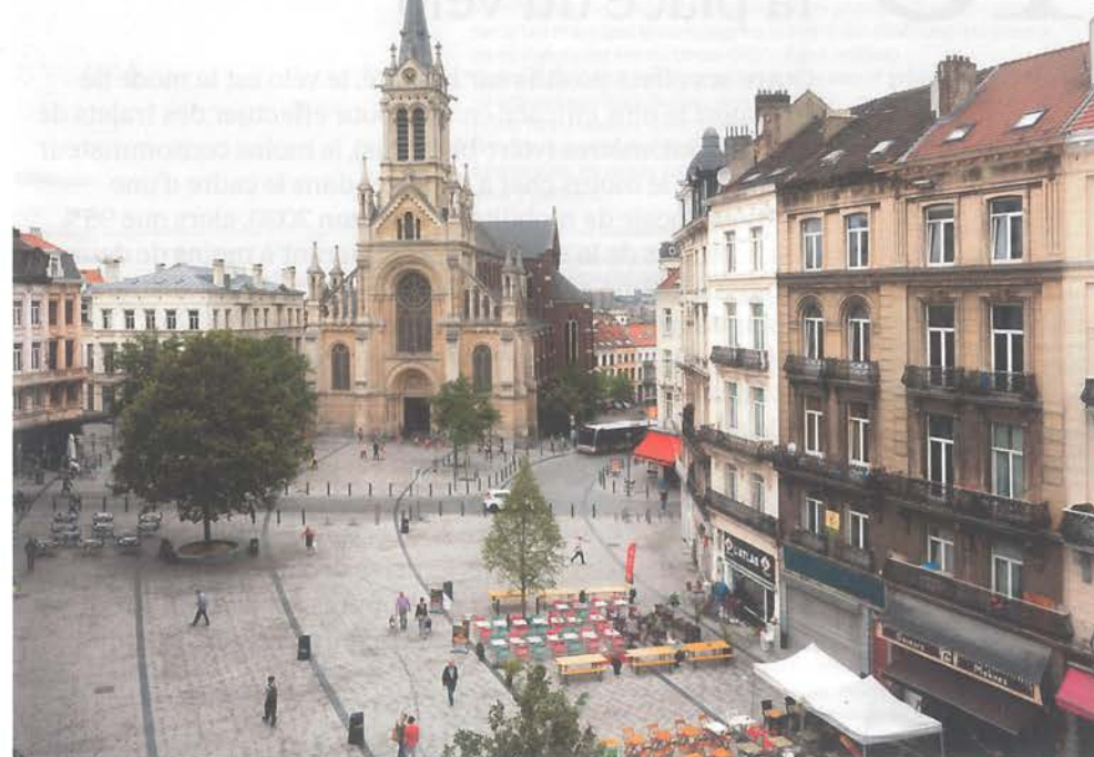
Sur le parvis Saint-Gilles à Bruxelles, un sol au dessin et au nivellement continu et une disposition et un écartement des potelets adapté favorisent la continuité et la liberté des parcours piétons. (Bureau Bas Smets)
