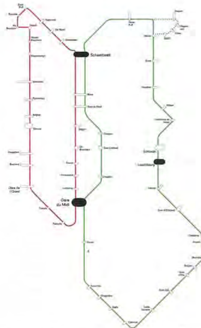
Project voor de reorganisatie van het Brussels openbaar vervoer, in twee lussen die gebruik maken van de bestaande spoorinfrastructuur (treinen en premetro).
